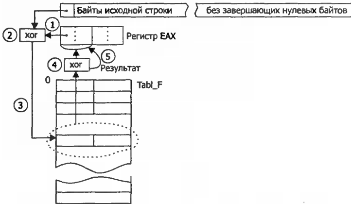
Рис. 9.9. Схема вычислений CRC с использованием прямого табличного алгоритма
