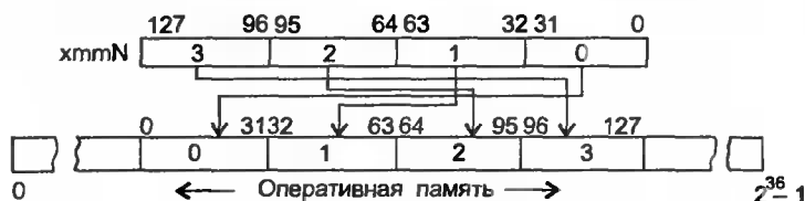
Рис. 10.16. Схема расположения в памяти данных формата XMM
