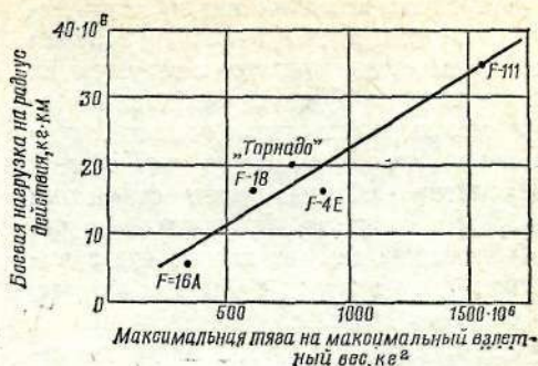
Рис. 3. Зависимость боевых характеристик некоторых современных самолетов (производство боевой нагрузки на радиус действия) от их конструктивных параметров (производство максимальной тяги силовой установки на максимальный взлетный вес самолета)
