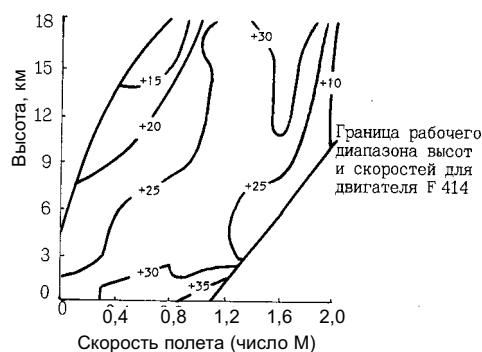
Рис. 2. Увеличение располагаемой тяги (в проц.) двигателя F414 по сравнению с F404 в зависимости от высоты и скорости полета на максимальном форсированном режиме и при стандартной атмосфере
