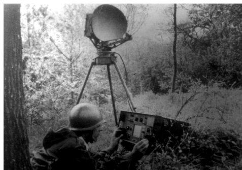
Рис. 3. Французская станция РНДЦ «Расит-72А»
