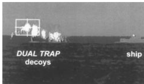
Рис. 3. ИК-изображение после применения ловушек «Дуал Трэп» из ПУ MASS
