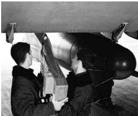
Рис. 8. Внешний вид и установка французской станции DDM на самолет
