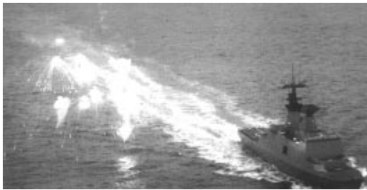
Рис. 1. Постановка фрегатом ВМС Китая ИК ЛЦ из ПУ «Дагэ» Mk2
