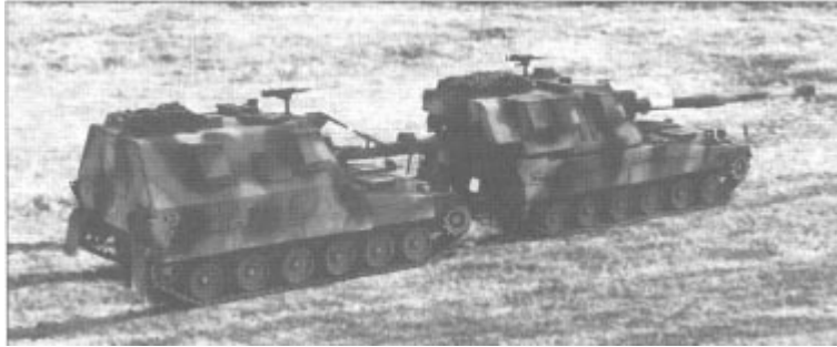
Рис. 2. 155-мм самоходная гаубица AS90B (справа) и транспортно-заряжающая машина во время загрузки боеприпасов
