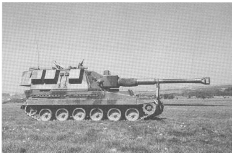
Рис. 1. 155-мм самоходная гаубица AS90 со стволом длиной 39 клб
