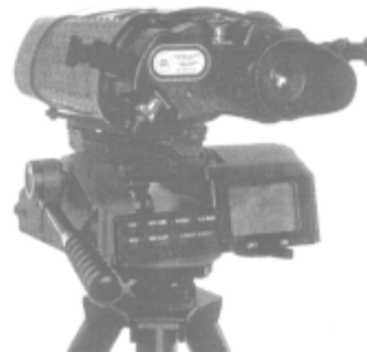
Рис. 2. Дальномер ESLR-1000 в комплекте с цифровым угломером в боевом положении
