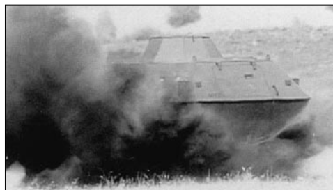
Цельносварной корпус БМ «Кобра» выдерживает взрыв под колесом противотанковой мины массой до 7 кг
