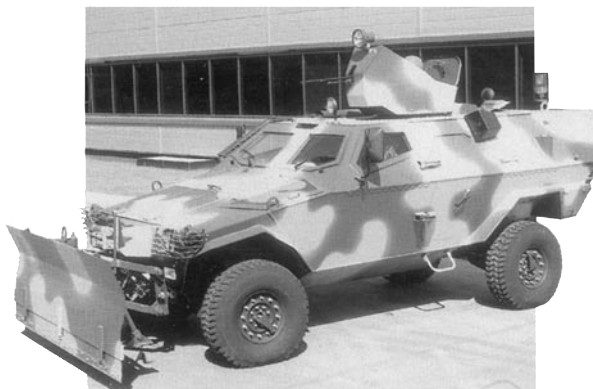
БММ EOD BRAAT предназначена для поиска, обезвреживания или уничтожения взрывоопасных предметов, которые остаются после огневого удара противника
