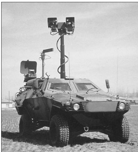
Боевая разведывательная машина ARSV, созданная на базе БТР «Кобра», предназначена для ведения разведки на поле боя с помощью оптико-электронных средств и передачи данных командованию
