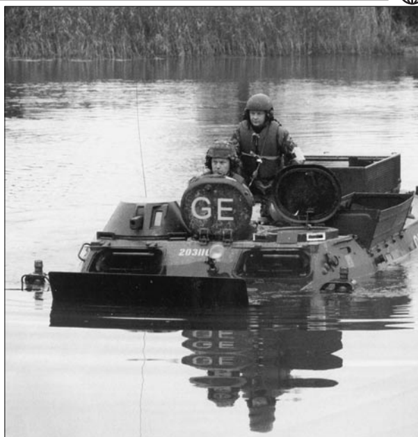
Шведский гусеничный плавающий бронетранспортер Pbv 401 преодолевает водную преграду глубиной свыше 1,5 м
