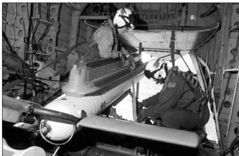
Крепление минно-поисковой ГАС AN/AQS-14 на вертолете MH-53E из состава 15 противоминной эскадрильи (слева) после применения на учениях в Персидском заливе в июне 2004 года (справа)
