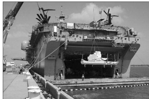
Погрузка неконтактного трала Mk 105, предназначенного для нейтрализации электромагнитных мин с вертолетов MH-53E, на борт УДК «Батаан» (ДРВ-5) в порту Инглсайд (штат Техас) при подготовке к учениям «Панамакс» в июле 2005 года
