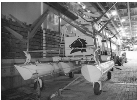
Противоминная система Mk 105 на платформе катамаранного типа на борту ДВКД «Дюбюк» (LPD-8) на учениях «Римпак-2004» в Тихом океане
