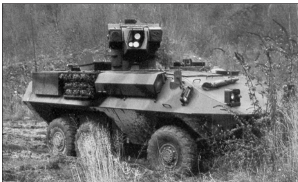
На вооружении сухопутных войск Швейцарии находится 120 самоходных ПТРК ТОУ на базе БТР «Пирана»
