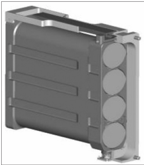
Внешний вид магазина пусковой установки MASS
