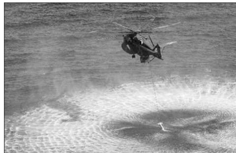
Крепление минно-поисковой ГАС AN/AQS-14 на вертолете MH-53E из состава 15 противоминной эскадрильи (слева) после применения на учениях в Персидском заливе в июне 2004 года (справа)
