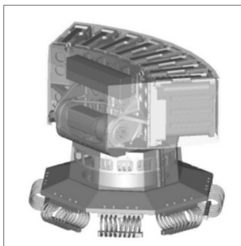
Эскиз внутреннего устройства ПУ MASS
