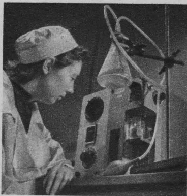
Электронный прибор целлоскоп за полминуты подсчитывает многие тысячи живых клеток, выросших вне организма
