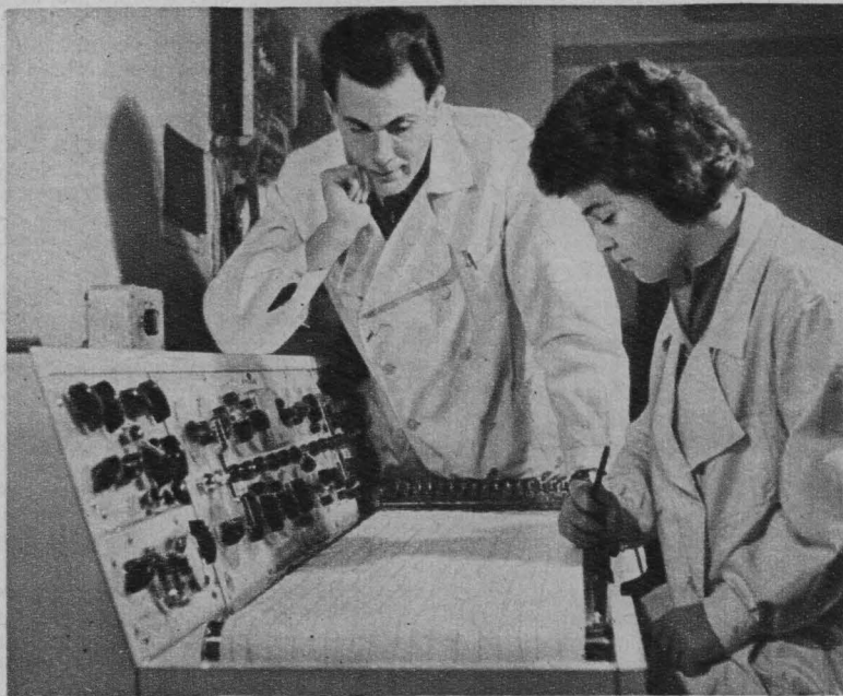
С помощью 16-канального электроэнцефалографа можно получить всестороннюю характеристику деятельности нервной системы человека
