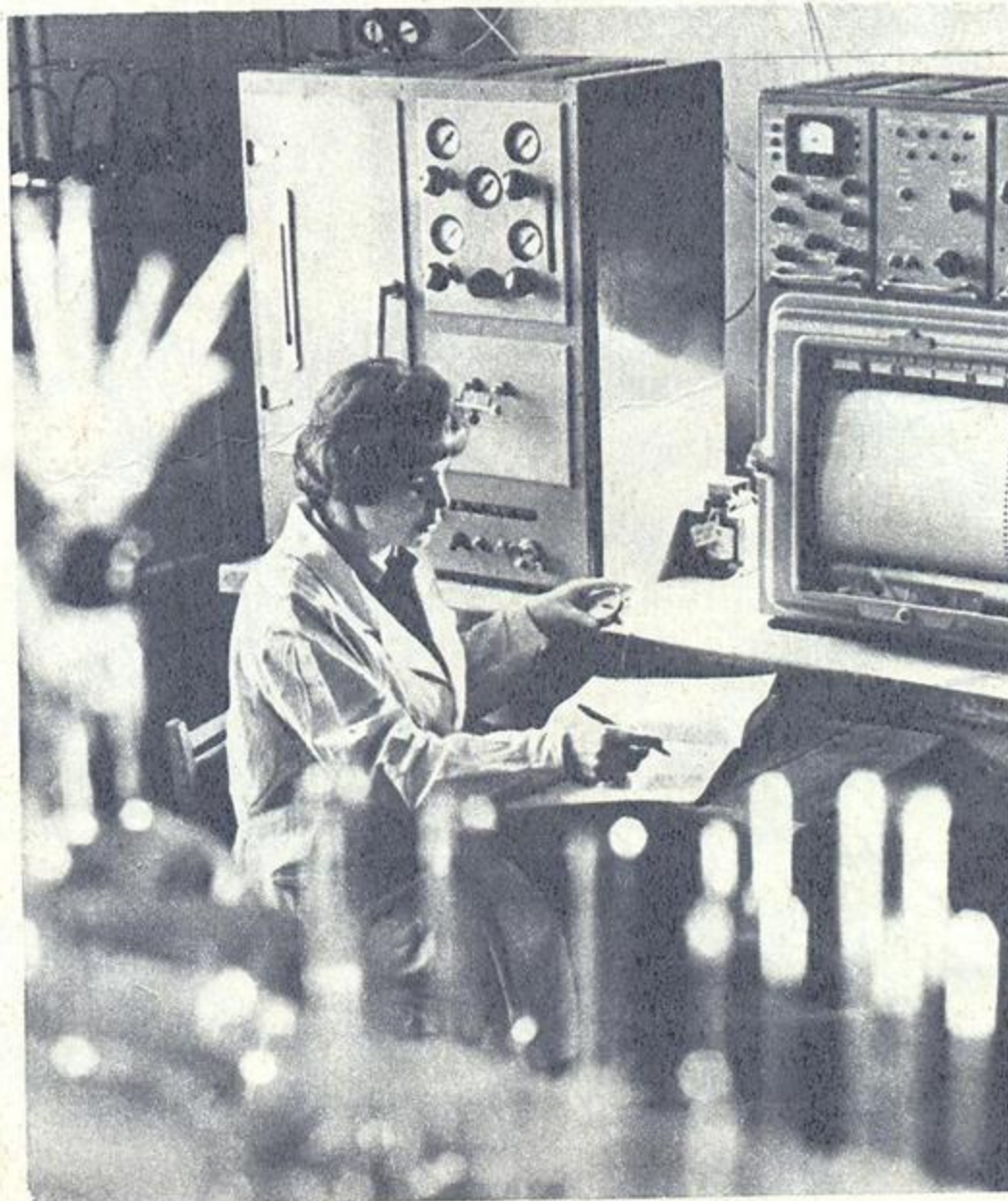
Быстро и точно определить содержание любого вещества, находящегося в смеси с другими, позволяет газовый хроматограф.
