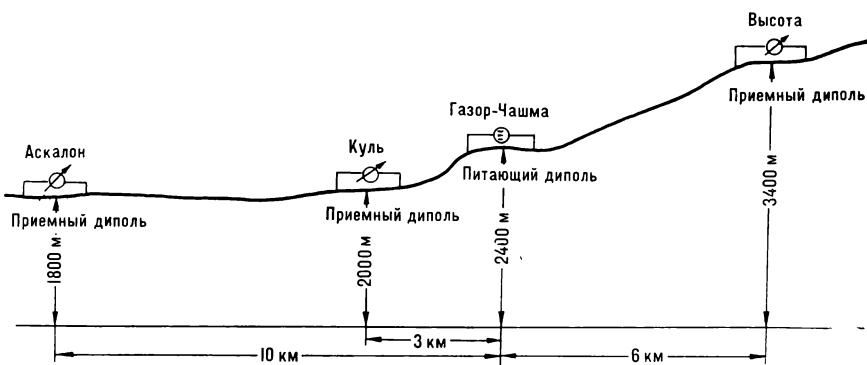
ред сейсмическим ударом в гипоцентральной зоне (зона очага землетрясения) могут изменяться электрические свойства горных пород, в частности, их электропроводность. Измерить ее на глубине можно методом **дипольных электрических зондирований**. Через два электрода (питающий диполь) в землю пропускается электрический ток. На некотором расстоянии также с помощью двух заземленных электродов (приемный диполь) измеряется разность потенциалов.
