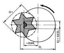
Схема асферизации зеркала путем увеличения кривизны его центральных зон (вверху) и путем увеличения кривизны его краевых зон (внизу). Стрелками показаны направления движения звездчатого молировальника  $(D_2=0.7D_1, 2de\ D_1$ — диаметр изготовляемого зеркала)
