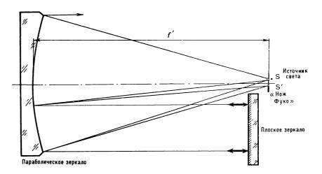
Схема теневого испытания зеркала по схеме Ричи
