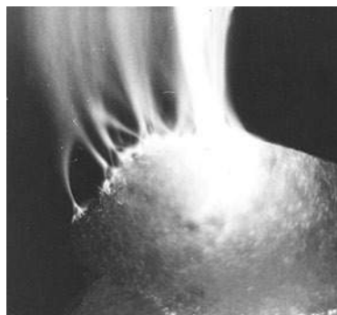
Электрический разряд с тающего ледяного электрода, радиус кривизны 1 сантиметр
