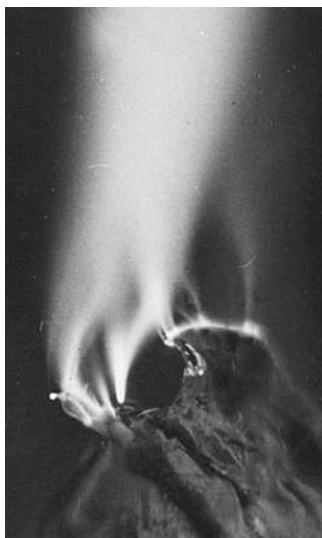
Электрический разряд с тающего снежка, радиус кривизны 1 сантиметр
