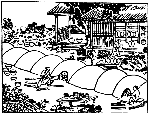
Рис. 26. Секционные печи для обжига керамики.
