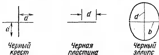
Рис. 7.9. Конфигурации стержней, используемые при расчетах поглощающих поверхностей
