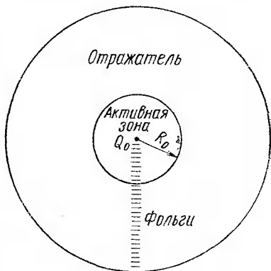
Рис. 8.2. Схема проведения измерений во французском эксперименте
