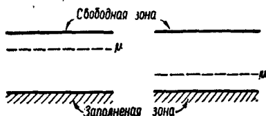
Рис. 128. Энергетические диаграммы p - и n -германия до плотного соприкосновения.
