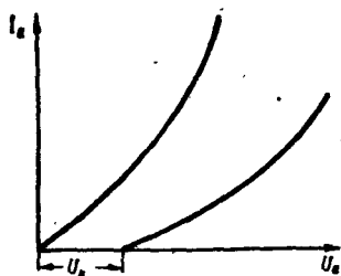
Рис. 123. График зависимости анодного тока от анодного напряжения при различных геометриях электродов.
