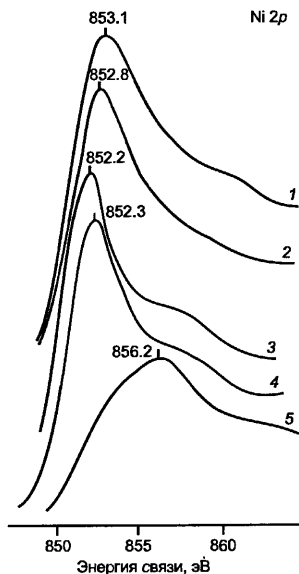
Рис. 2.29. Данные РФЭС о состоянии никеля в сульфидных катализаторах \text{NiS}/\text{Al}_2\text{O}_3 , приготовленных с использованием аминных комплексов никеля:
