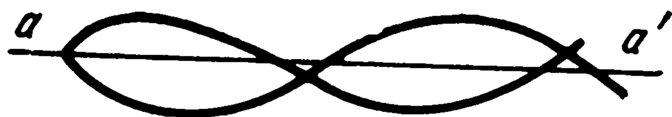
Рис. 3-2. Электронный пучок в длинной магнитной линзе.
